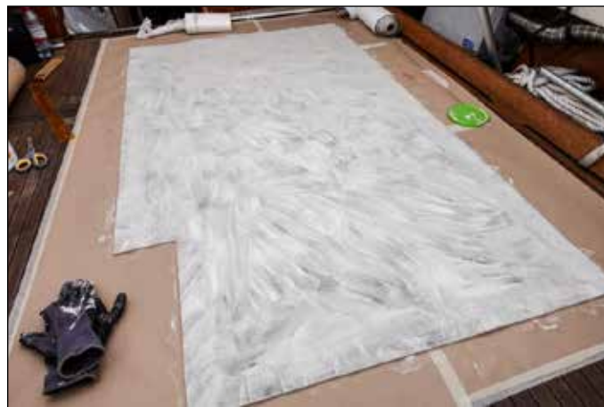
6. Var noga med måtten. Mät, märk ut på din mall, och kontrollmät sedan igen. Håll upp din tillskurna bit innan du kletar på lim så att du ser att den passar.
