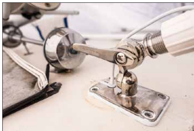
4. Passa på att installera andra detaljer som påverkas av takrenoveringen. Som en ny VHF-antenn med fäste.
