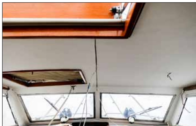
13. Såja – hela innertaket på Clara-Ida är ditlimmat och klart. Räknat i effektiv tid har handlade det om cirka två fulla helgers jobb, eventuellt lite mer för skrapning och väntetid på att limmet ska torka.
