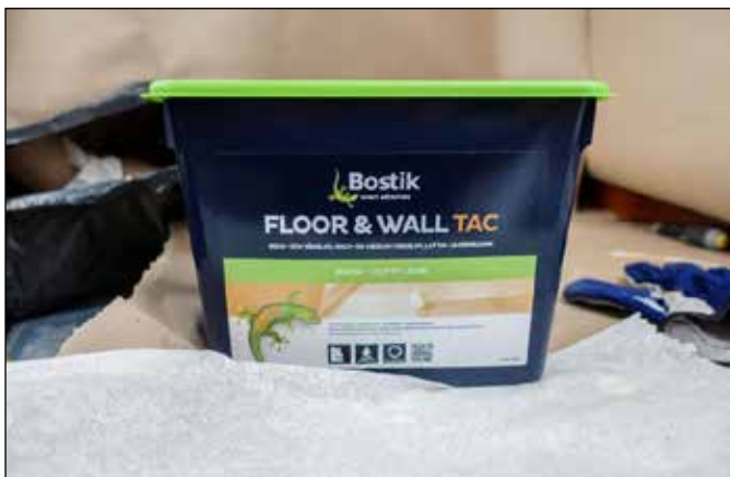
7. Golvlim fungerar bra för taklimning. Det tillåter att man drar i det om det blir snett första gången. Men se till att limmet torka upp till cirka 50 minuter innan du pressar fast materialet..
