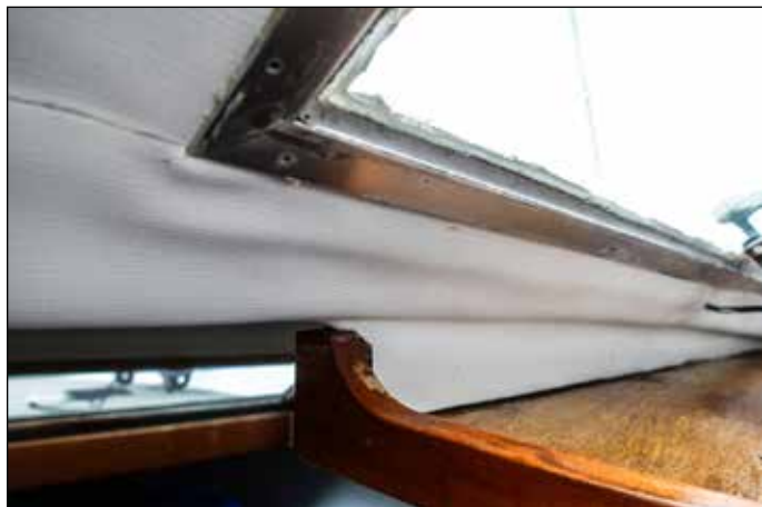
12. Elkablar som måste limmas in bakom tyget ställer ibland till problem, som här. Fäst sladdarna med buntband före limning, men se till så inte buntbanden skaver i tyget som appliceras. Ett bra trick: när en elkabel fäster på den limmade ytan är den torr nog för att tygmaterialet ska kunna pressas på.
