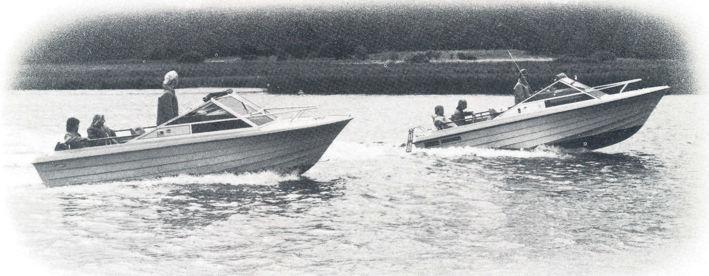
Samma båttyp. Samma fart. Samma belastning. Den högra båten "plöjer" tungt i vattnet. Den vänstra, med Insta-Trim går plant.
